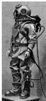
Tungdykarutrustningen utvecklades under 1800-talet. Bilden från Svenska Familjjournalen 1883 visar också fotogenlampa för undervattensbruk.
